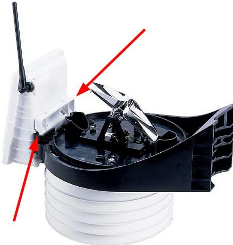
Durch Auflegen der Schraubenzieherspitze auf den schwarzen Plastikbalken kann der weisse Keil angehoben werden. Bitte an beiden Seiten jeweils leicht anheben und immer wieder abwechseln, bis sich der ganze Keil löst.
